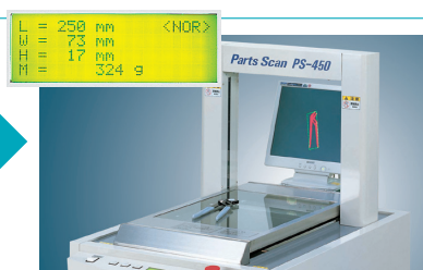
ゲートが戻ると測定が終了、幅・高さ・長さ・質量を表示
