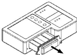
ネジを外し、電池ケースを取外します。
