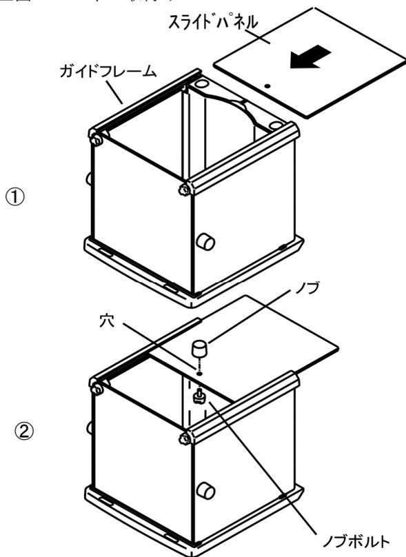
①スライドパネルを、ガイドフレームに挿入します。(矢印方向)
