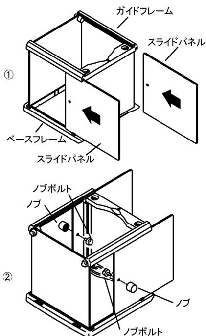
①スライドパネル（2ヶ）をガイドフレームとベースフレームに挿入します。（矢印方向）
