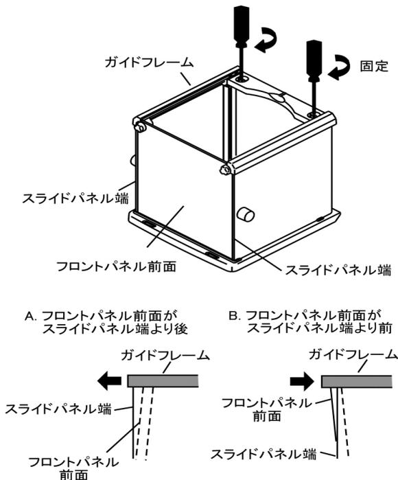
①フロントパネル前面とスライドパネル端がほぼ平行となるようガイドフレームを矢印方向に調整し（左図A、B参照）、M4ネジ（2ヶ所）で固定します。
