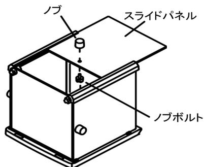
①上面のスライドパネルに取付けられているノブボルトを回し、ノブを取外します。
