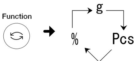
[Function] キーを押します。押すたびに表示単位が切替ります。
