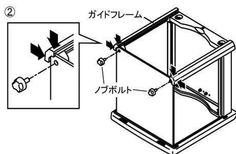
②ガイドフレームを矢印方向に押し付けながら、ノブボルト（2ヶ）によりフロントパネルとガイドフレームを固定します。
