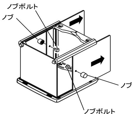
左右面のスライドパネルに取付けられているノブボルトを回し、ノブを取外した後に、左右面のスライドパネルを引き抜きます。
