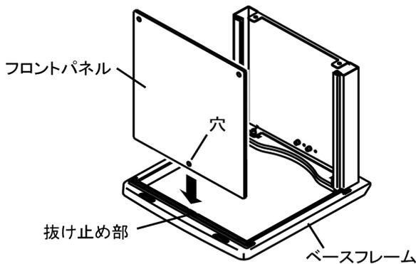
①フロントパネルをベースフレームに差し込みます。
