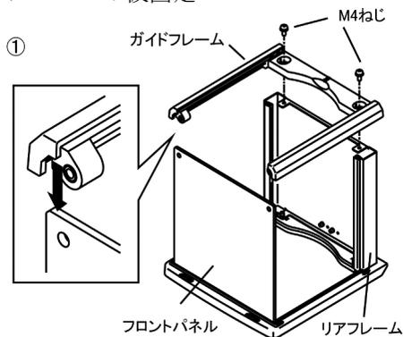
①ガイドフレームをフロントパネルに差し込み、M4ネジ（2ヶ）でリアフレームに仮固定します。
