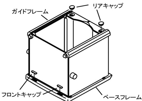
①ベースフレームに、フロントキャップ及びリアキャップを押し込みます。
