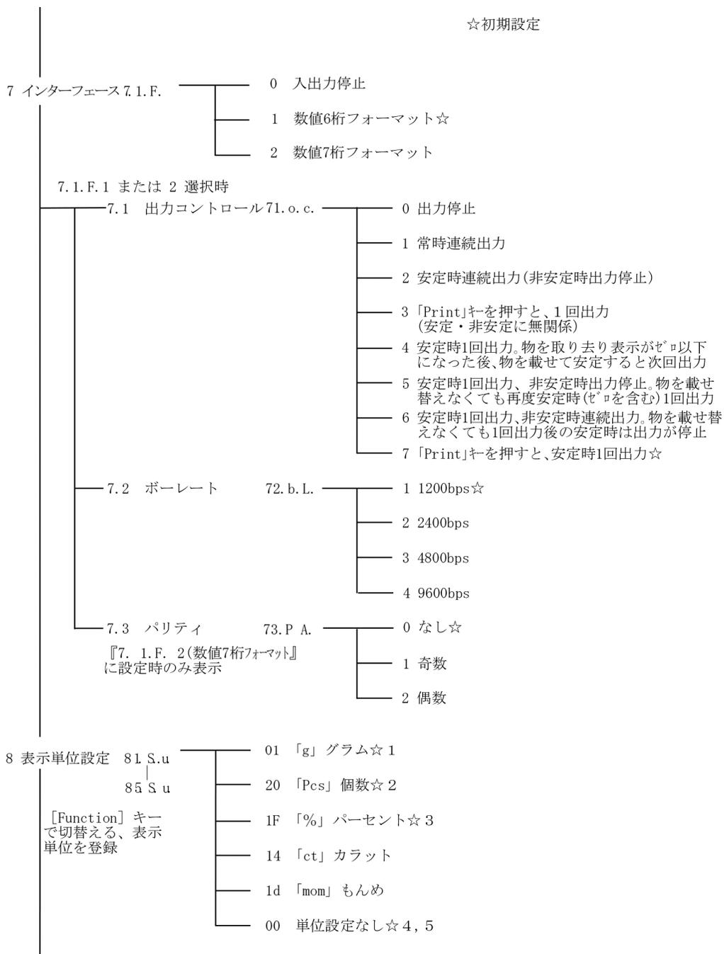
※ 連続出力のデータ間隔は0.1～1秒です。(間隔は計量状態等により変動します。)
