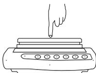
計量皿を指で押して、表示部の表示が変化することを確認します。
