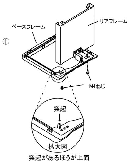
①M4 ネジ (2ヶ) でベースフレームとリアフレームを仮固定します。
