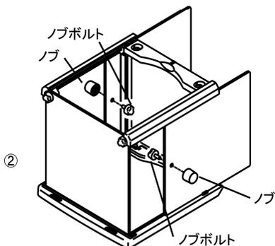
②各スライドパネルの穴に、ノブボルトを通しノブを取付けます。
